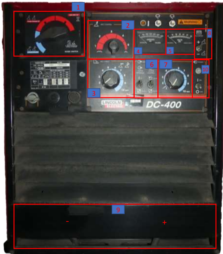
Gambar 2. Penjelasan panel Mesin Las Lincoln DC400
