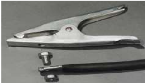
Clamp penghubung kutub negatif ke meja kerja atau material
